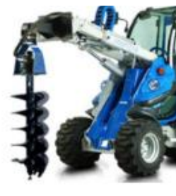
УСИЛЕННЫЙ БУР ДЛЯ ПОСАДКИ ДЕРЕВЬЕВ
